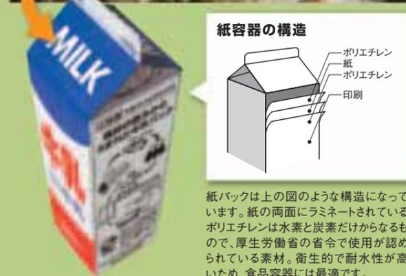
紙パックは上の図のような構造になっています。紙の両面にラミネートされているポリエチレンは水素と炭素だけからなるもので、厚生労働省の省令で使用が認められている素材。衛生的で耐水性が高いため、食品容器には最適です。
