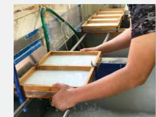
型枠を使った手すき作業
