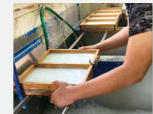
型枠を使った手すき作業
