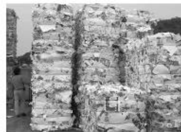
●古紙業者(成和商事)がベラー加工、ヤード保管
