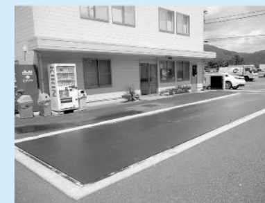
●回収トラックごと重量計測可能な装置
